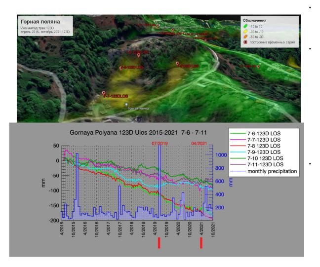
Утром 5 октября 2021 после дождя, мощный оползень сошел по горному склону на сотню метров, утащив с собой большую часть котеджного поселка «Горная поляна». Мы проанализировали временные серии смещений на трех участках этоо оплзневого склона
